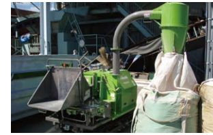
木くず破碎設備
